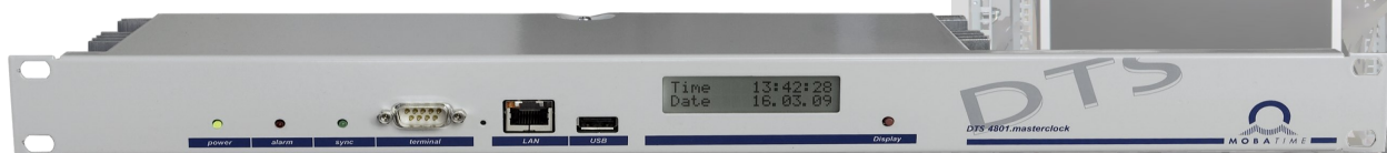
DTS - pohled na přední panel s LED diodami, displejem a konektory.
